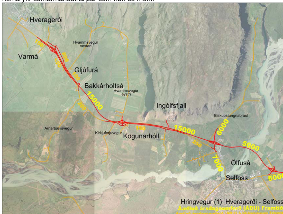
Mynd 3-22 Áætluð framtíðarumferð (~2030) á Suðurlandsvegi og í nágrenni hans eftir færslu vegarins norður fyrir Selfoss og gerð hliðarvega, ökutæki á sólarhring (ÁDU).
